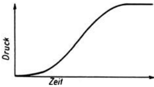
Abb. 23. Druck-Zeitkurve beim Abtrennen eines degressiven Pulvers in der Verbrennungsbombe
