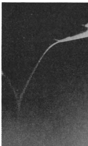
Abb. 44. Zeitlich aufgelöste Leuchterscheinung beim Verbrennen eines Knallgasgemisches. Die Zündstelle liegt am Gabelpunkt (Dixon 87) )
