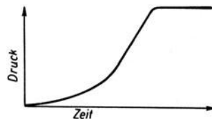
Abb. 24. Druck-Zeitkurve beim Abtrennen eines progressiven Pulvers in der Verbrennungsbombe
